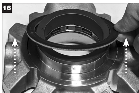
16 Ta bort packningen från adaptern och kassera den.
