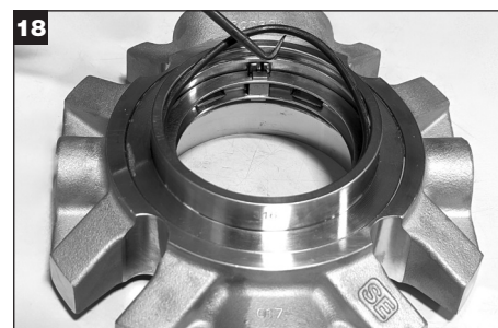
18 Ta bort den invändiga, stationära o-ringen (X) från adaptern och kassera den.
