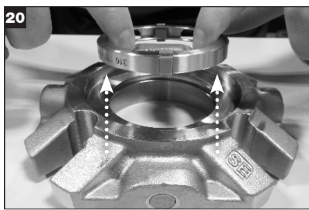
20 Ta bort drivkanalen från glanden. Ta bort kanal-klämmorna och flödesdetektorn från drivkanalen och kassera dem.
